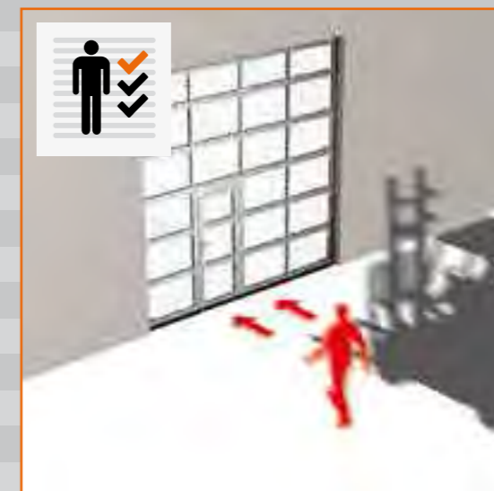
Schlupftür für Menschen, integriert in das Sektionaltor für Güter.
