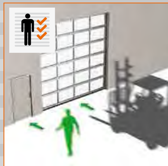
Türen und Tore für Menschen und Güter vollständig getrennt.
